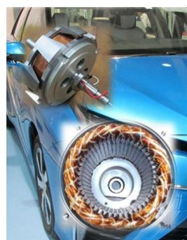
現在の電気自動車用モータには高性能磁石が必要不可欠です。しかし、この磁石は高価だけでなく、高速走行時において高効率を維持できません。私たちは、磁石を用いることなく、どのような速度で走行しても常に高効率を実現できるモータを開発しています。
