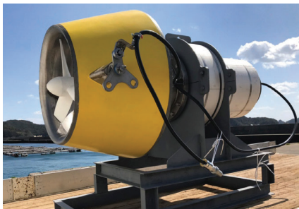
五島市で実証試験中の 潮流発電タービン
